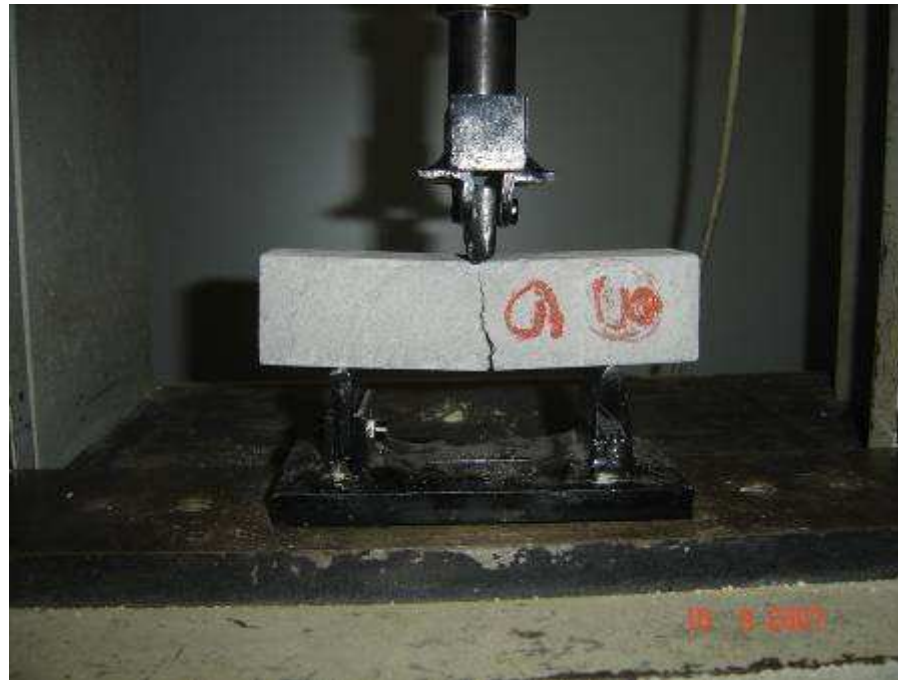
Corpo de prova PRISMÁTICO - 4x4x16 cm
