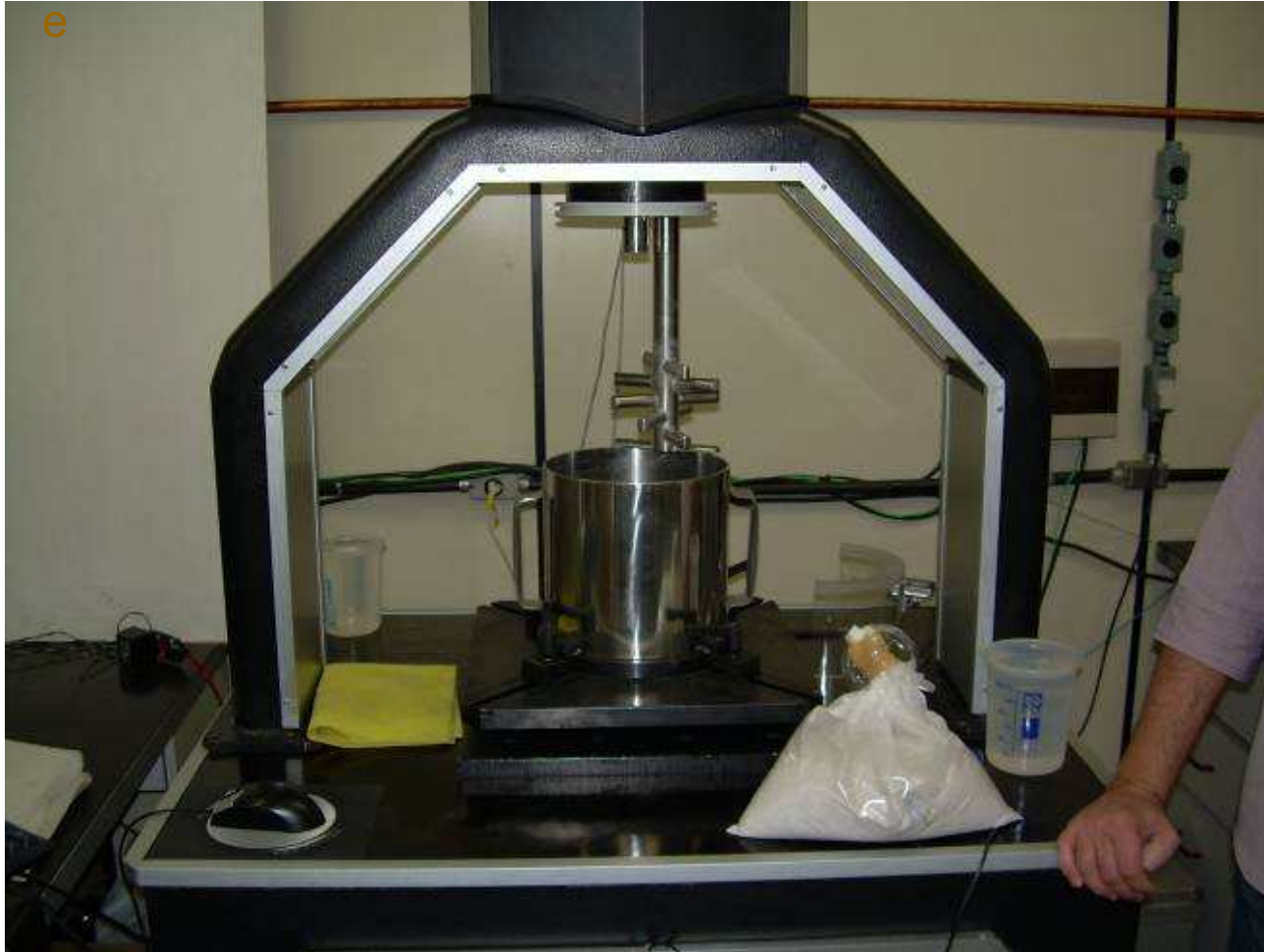
Controle do comportamento reológico durante a Mistura Equipamento do Laboratório de Materiais da EPUSP
