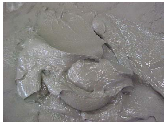
Figura 4 – Pasta de cimento e água.
