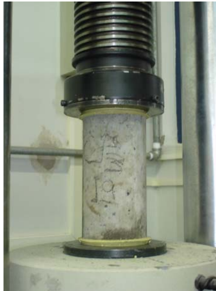
Figura 67 – Corpo-de-prova cilíndrico em ensaio para determinação da resistência à compressão do concreto (Fotografia de Obede B. Faria).
