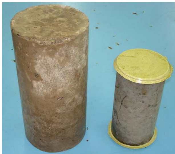
Figura 66 – Corpos-de-prova cilíndricos 15 x 30 cm e 10 x 20 cm para determinação da resistência à compressão de concretos (Fotografia de Obede B. Faria).
