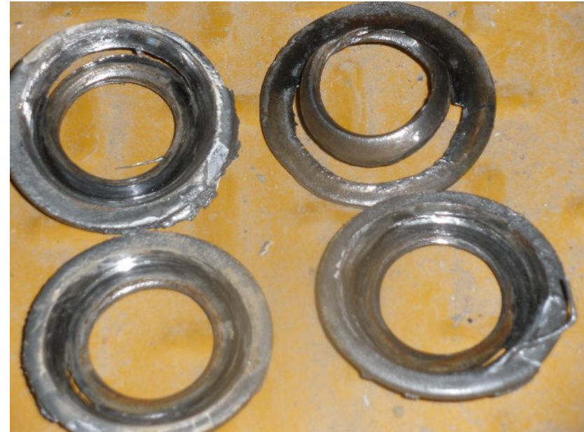
Anilhas esmagadas devido a aperto excessivo
