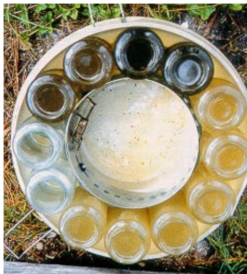
Figura 3.12 Amostradores de qualidade da água pluvial. Início da precipitação com a garrafa marrom (posição do relógio a 45 min).
