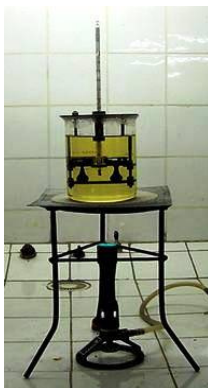
Figura 6: Ensaio do Ponto de Amolecimento
