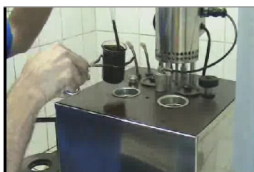
Figura 5: Imersão da emulsão no viscosímetro
