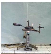
Figura 7: ensaio de ponto de fulgor
