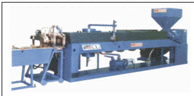
Foto 20 - Extrusora – Vista Longitudinal
